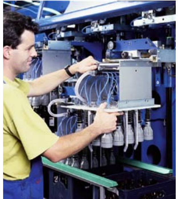
Schnelles und einfaches Wechseln des Greiferkopfes
