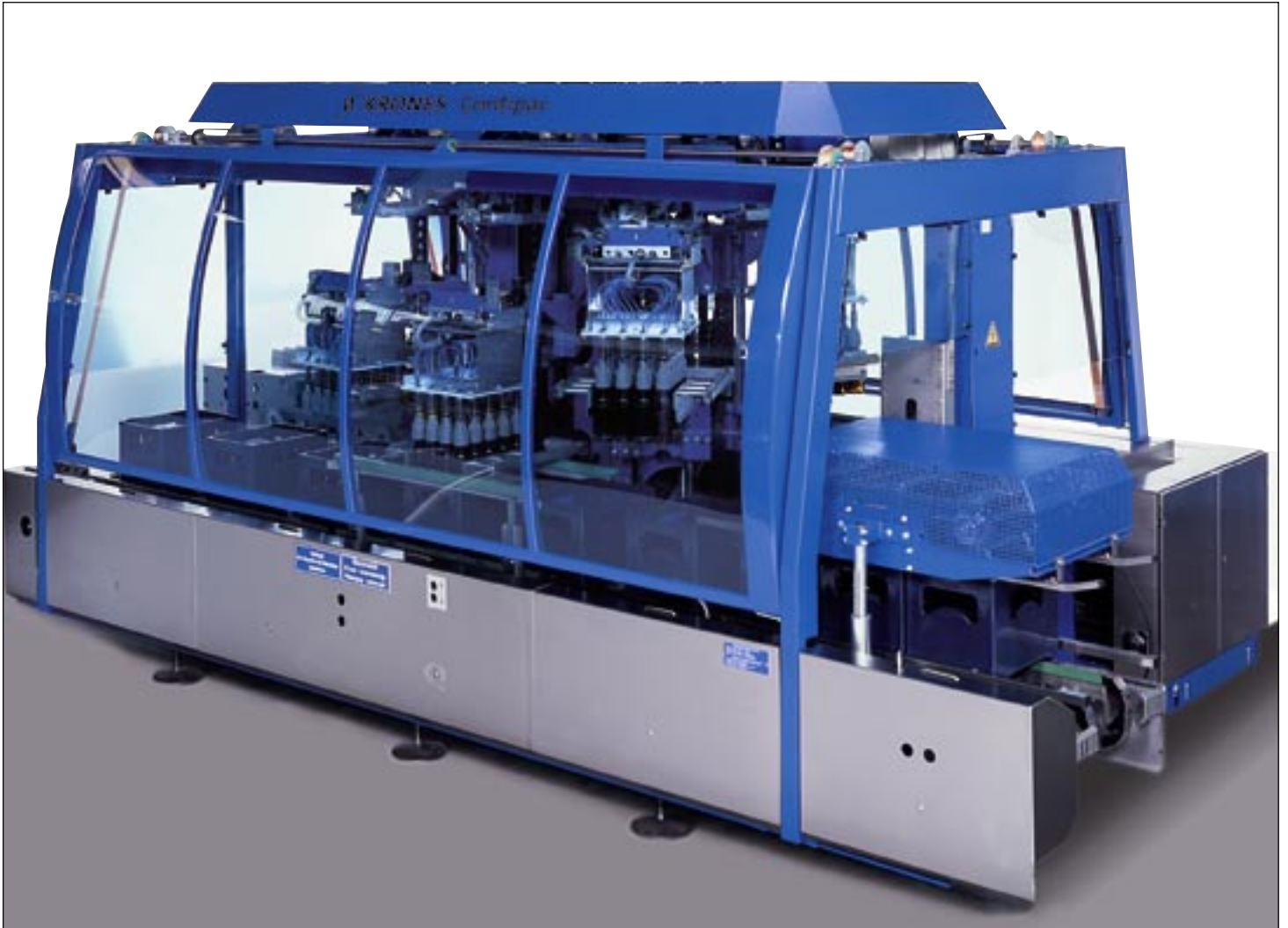
Contipac Einpacker mit acht Greiferköpfen
