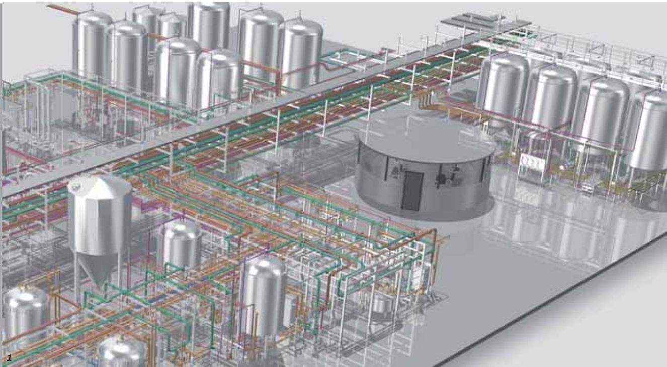
Fig. 2 Detalle de un puente de tubos principal
