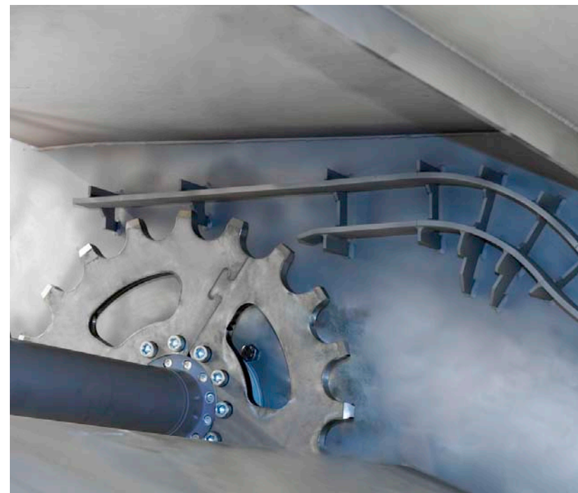
Las ruedas de cadena divisibles facilitan el mantenimiento.
