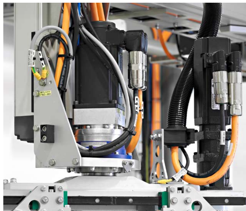
Compacta y de fácil acceso: la unidad de giro se encuentra por encima del cabezal de agarre
