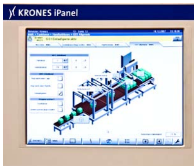
Facilidad de operación gracias a la pantalla táctil iPanel de KRONES.
