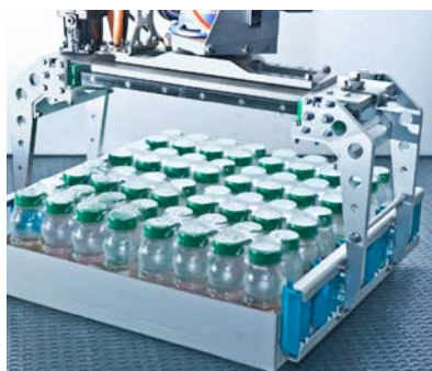
Los cabezales de agarre equipados de perfiles de plástico permiten un procesamiento protector de los embalajes.
