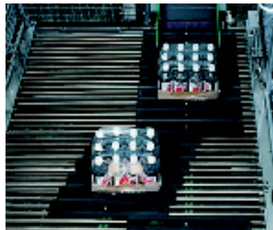
Selección y eliminación de bandejas defectuosas mediante distribuidor de placas portadoras
