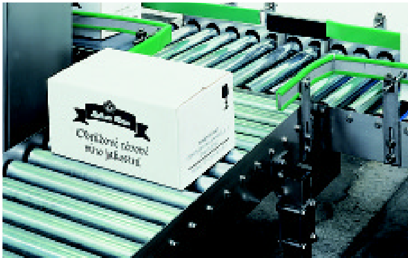
Eliminación en ángulo recto de cajas defectuosas mediante eyector
