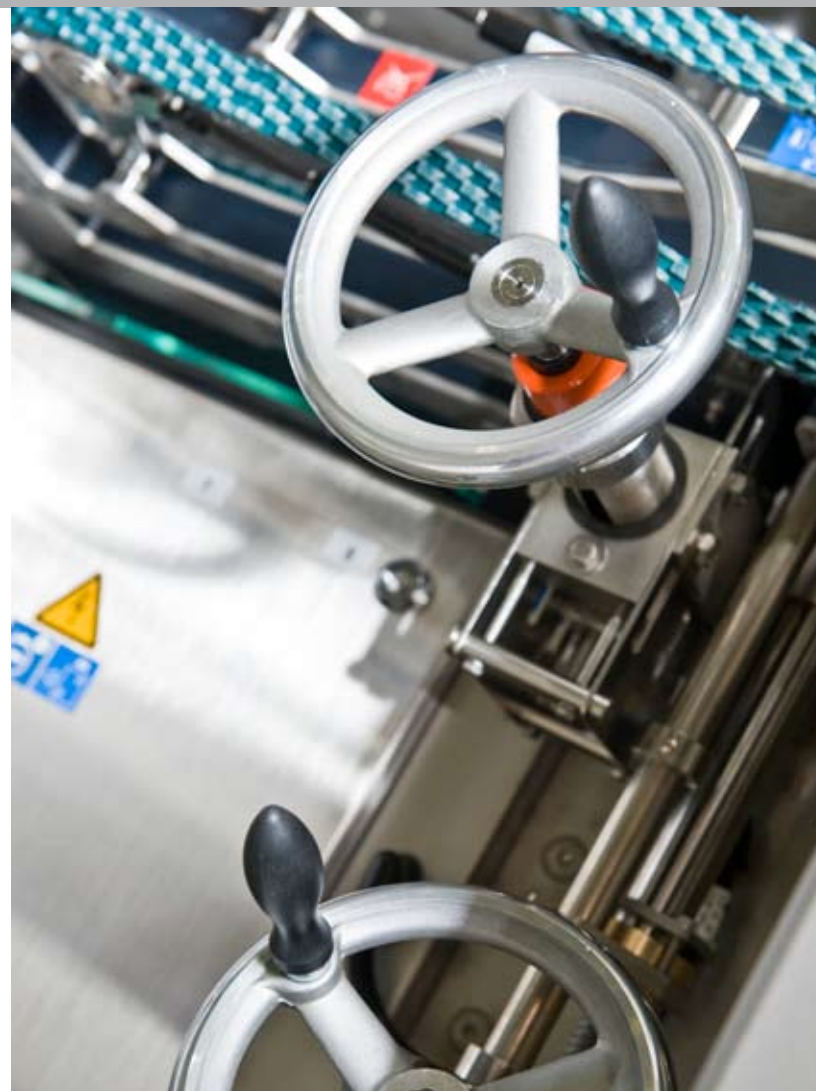
Mediante una manivela se ajustan las correas al nuevo tamaño de botella.
