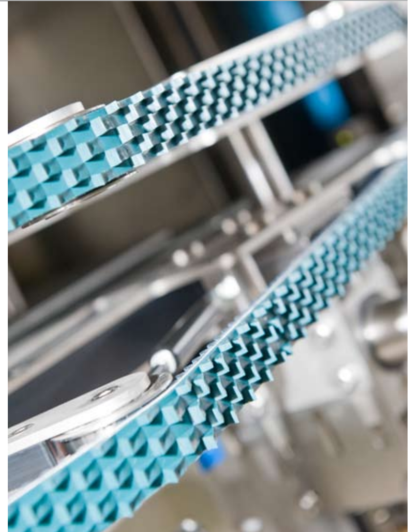
Guiado de envases con correas ajustables
