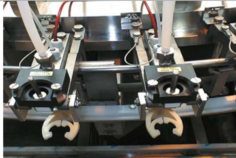
Botella girada quedando boca abajo durante el proceso de enjuague en la enjuagadora de dos canales
