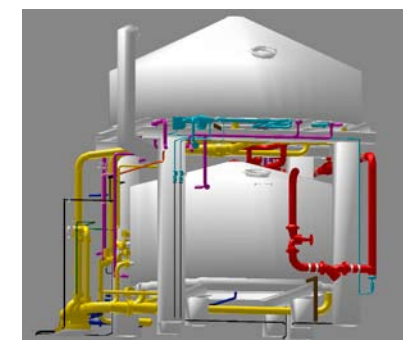
Ejemplo de tubería para Merlin instalado encima del whirlpool
