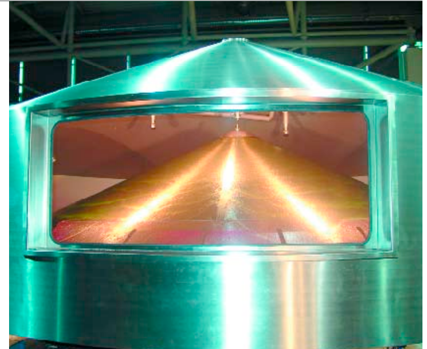
Sistema de cocción de mosto y stripping Merlin
